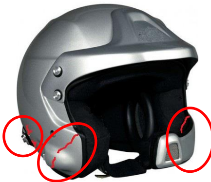
Fig. 4.8 – Pontos de falha mais comuns encontrados em capacetes
