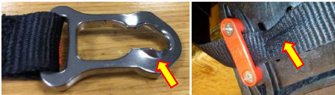
Fig. 5.6 – Exemplos de danos encontrados após acidentes. No lado esquerdo, deformação do ponto de ancoragem da tira no capacete; no lado direito, estiramento da retenção.
